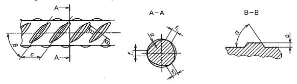
β: Rib inclinationc: Rib spacing
